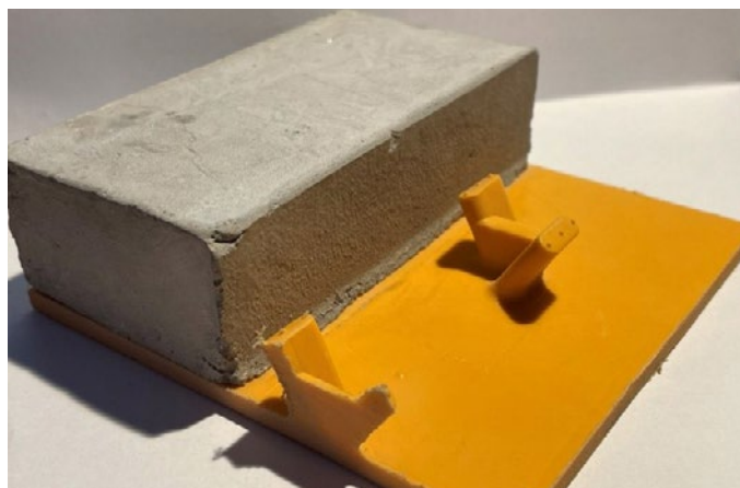
Próbka wkładki PEHD lub PP, zabetonowana w połowie
